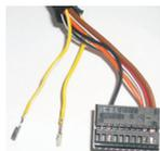
Рис. 3. Разъем блока COMAND отсоединенной шиной CAN
