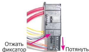
Рис. 2. Разборка разъема блока COMAND
