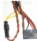
Рис. 4. Разъем блока COMAND после подключения модуля к шине CAN
