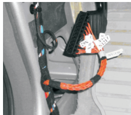
Рис. 4. Положение дистрибьютора в кузовах 164 и 251 (в левой передней боковине)
