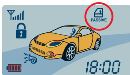
Если выбрано значение 4 программируемой функции 1-5, (см. стр. 69), то система в режим охраны не встает, а только включает блокировку стартера (зажигания) по истечении 30 сек. после выключения зажигания или по завершении режимов резервирования запуска, «Pit-Stop» и «Турбо».
