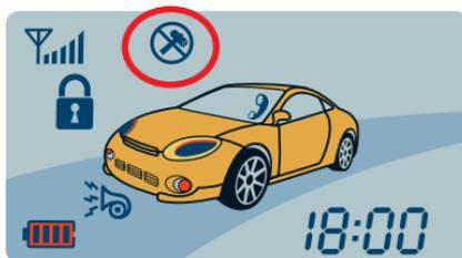
**При отключении датчика удара:**
